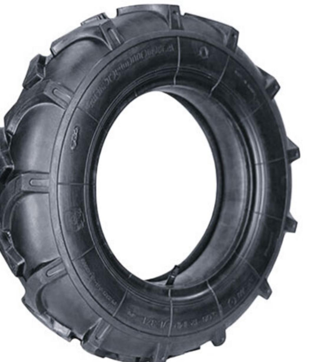
Шины стандартные с направленным рисунком протектора повышенной проходимости обеспечивает высокие тягово-цепные свойства на мягких грунтах и пониженное давление на грунт.
