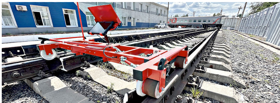
Одно из главных преимуществ тележки ПТ-12-01 в том, что она позволяет обрабатывать и анализировать информацию о состоянии пути в реальном времени
